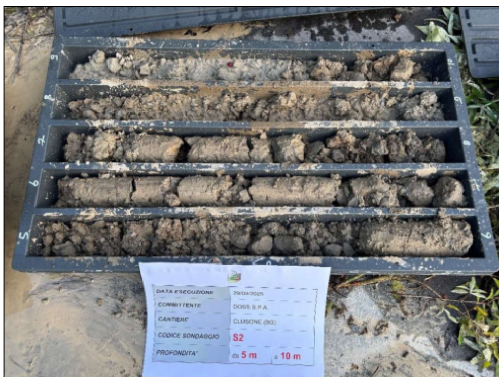
Figura 30 - Sondaggio S2, cassetta 5.00 – 10.00 m
