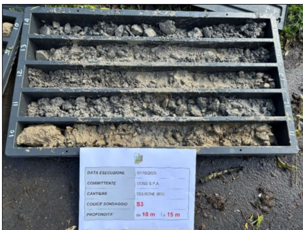
Figura 35 - Sondaggio S3, cassetta 10.00 – 15.00 m
