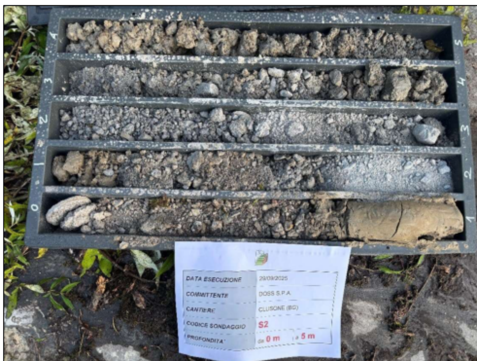
Figura 29 – Sondaggio S2, cassetta 0.00 – 5.00 m
