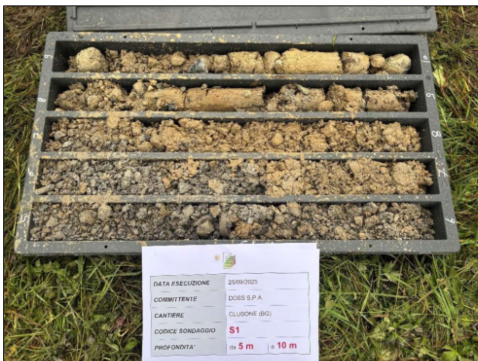
Figura 26 - Sondaggio S1, cassetta 5.00 – 10.00 m
