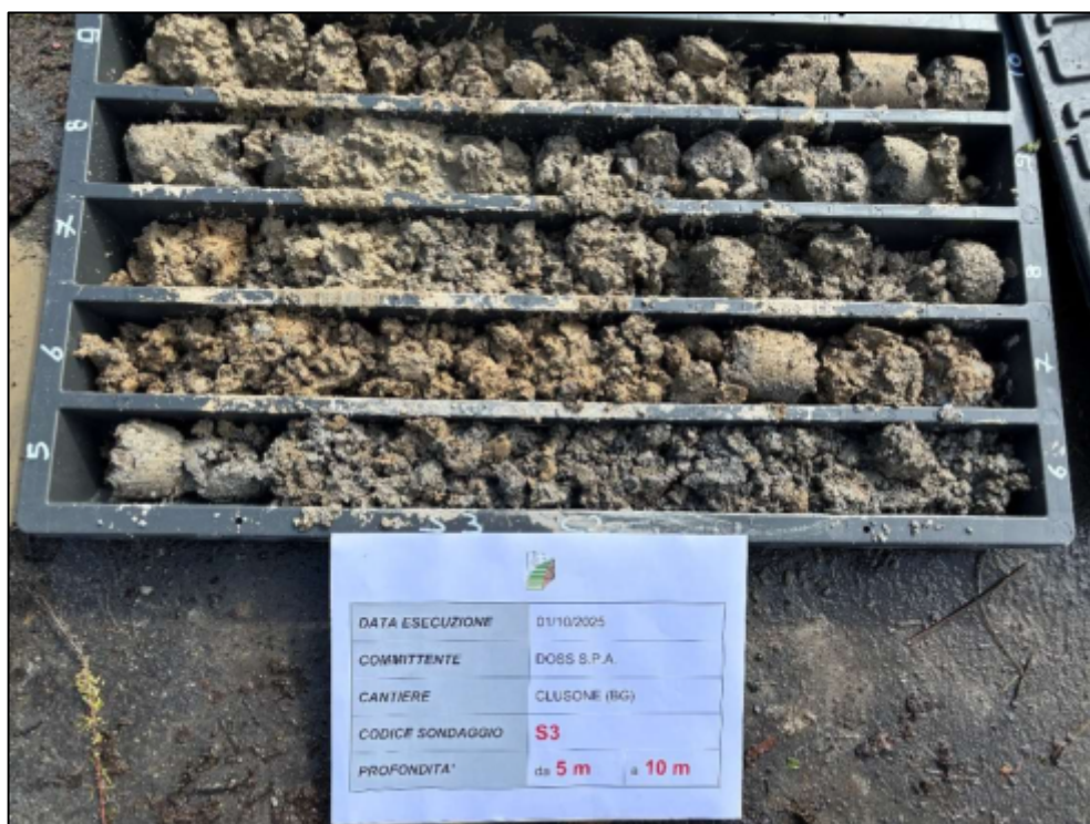
Figura 34 - Sondaggio S3, cassetta 5.00 – 10.00 m
