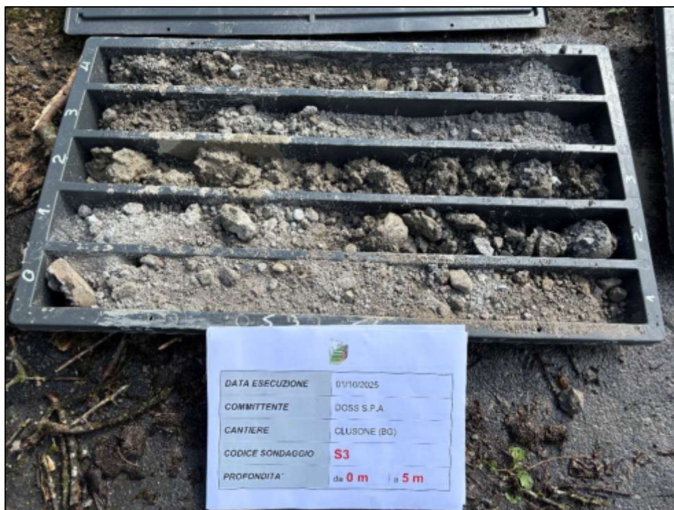
Figura 33 – Sondaggio S3, cassetta 0.00 – 5.00 m
