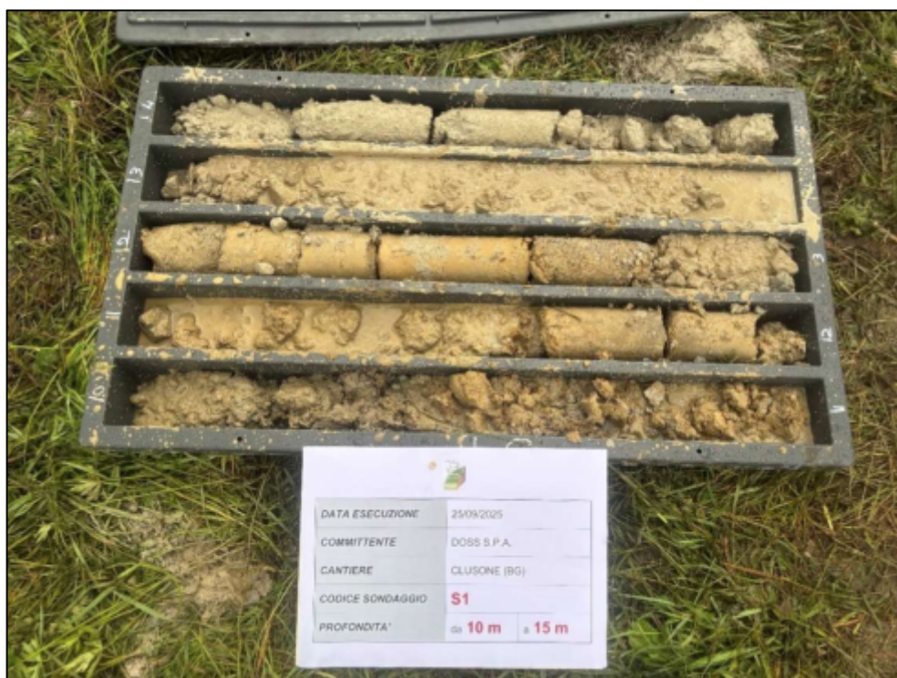
Figura 27 - Sondaggio S1, cassetta 10.00 – 15.00 m
