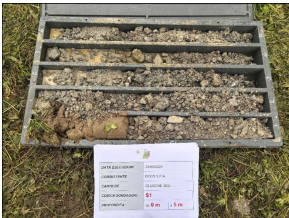
Figura 25 – Sondaggio S1, cassetta 0.00 – 5.00 m
